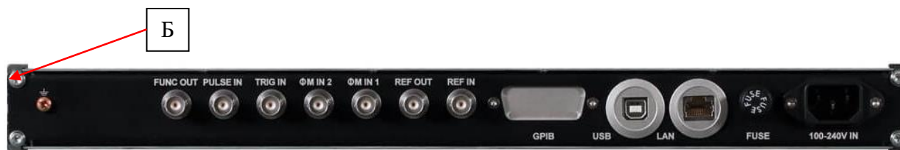
Рисунок 6 – Вид сзади модификаций RFS40-2, RFS40-3, RFS40-4 и схема пломбировки от несанкционированного доступа (Б)
